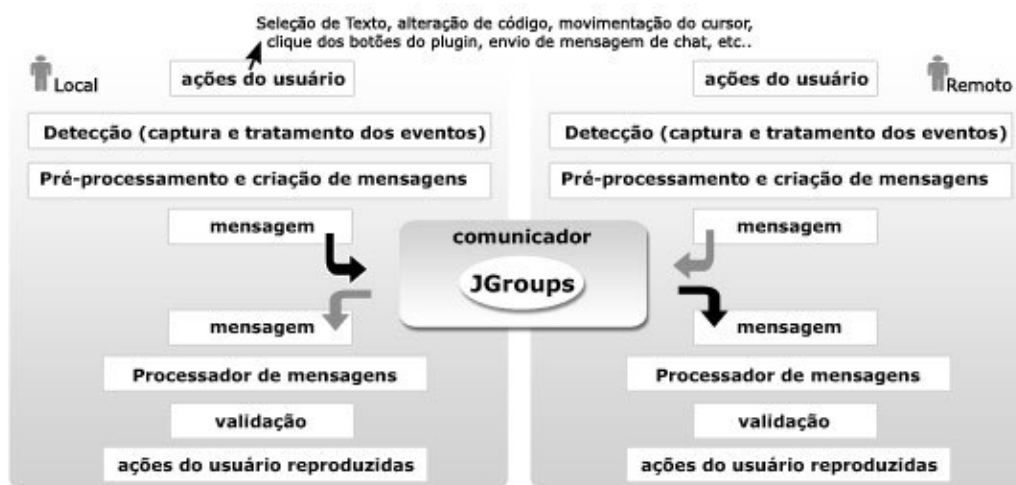
Figura 1. Esquema de Funcionamento do Plugin PEP
